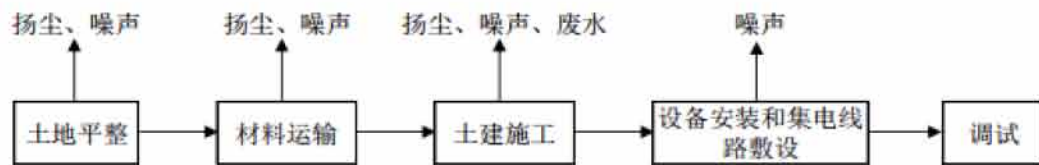
图 4.1-1 本工程施工期工艺流程与产污环节示意图
