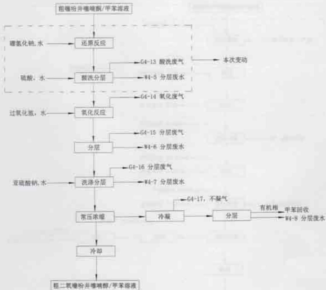
图 3.5-1 原批复环评中多佐胺生产工艺流程及产物环节示意图
